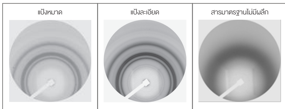
การกระเจิงรังสีเอกซ์เพื่อวิเคราะห์คุณสมบัติผลึกของแป้งด้วยเทคนิค Wide Angle X-ray Scattering (WAXS)
