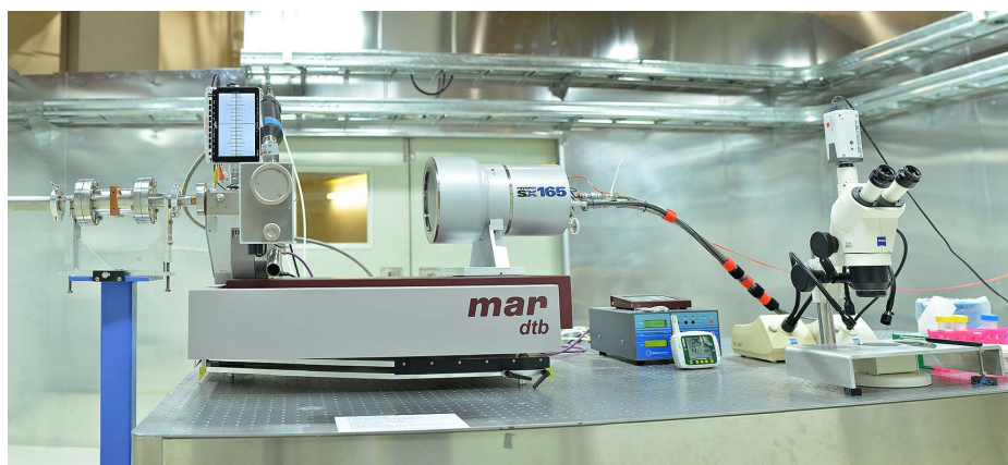
รูปที่ 31 แสดงระบบลำเลียงแสงและสถานีทดลอง 7.2W
